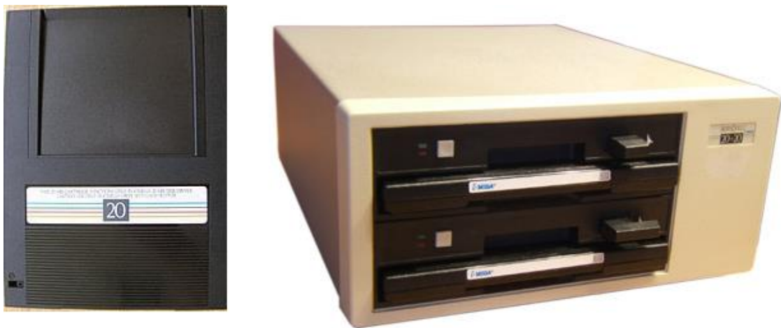
Imagen 4. Disquete y Disquetera sistema Bernoulli
